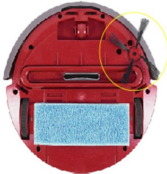
Figure 13 : Dévissez la vis qui sert du support de brosse latérale
